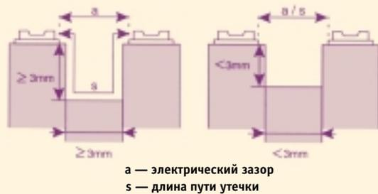
a — электрический зазор
