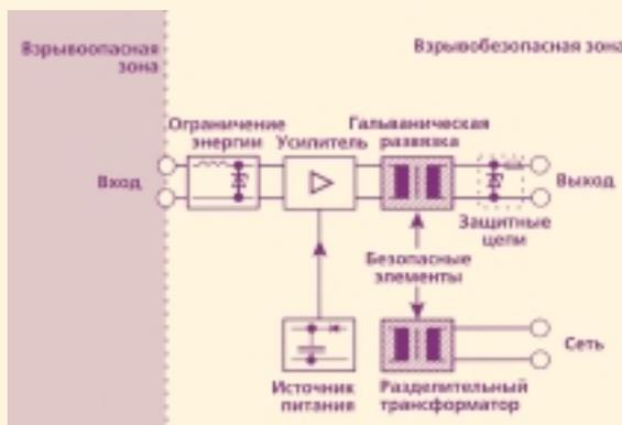
Рис. 15. Схема гальванически изолированного барьера
